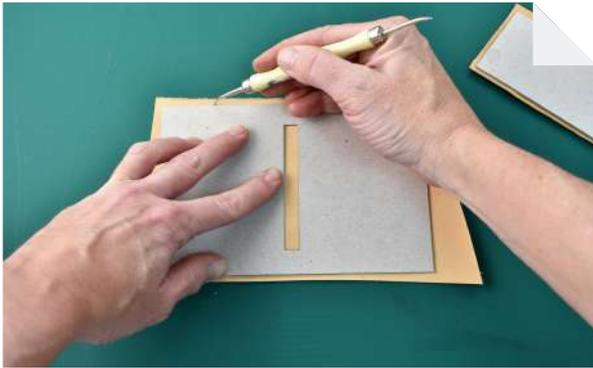
2. Una vez marcados los patrones, cortaremos por la línea resultante con ayuda del cúter y la regla metálica. Cuanto más limpio sea el corte, mejor el resultado final así que vigila que el cúter este bien afilado y trata de cortar el cuero de una sola pasada haciendo suficiente presión con el cúter sobre él.
